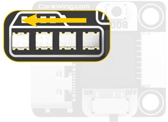
**说明：**□ 表示为亮灯状态，▣ 表示为灭灯状态，电压校准值来源于飞控，可通过修改飞控的参考电压参数通过来调整灯的电压变化效果。
