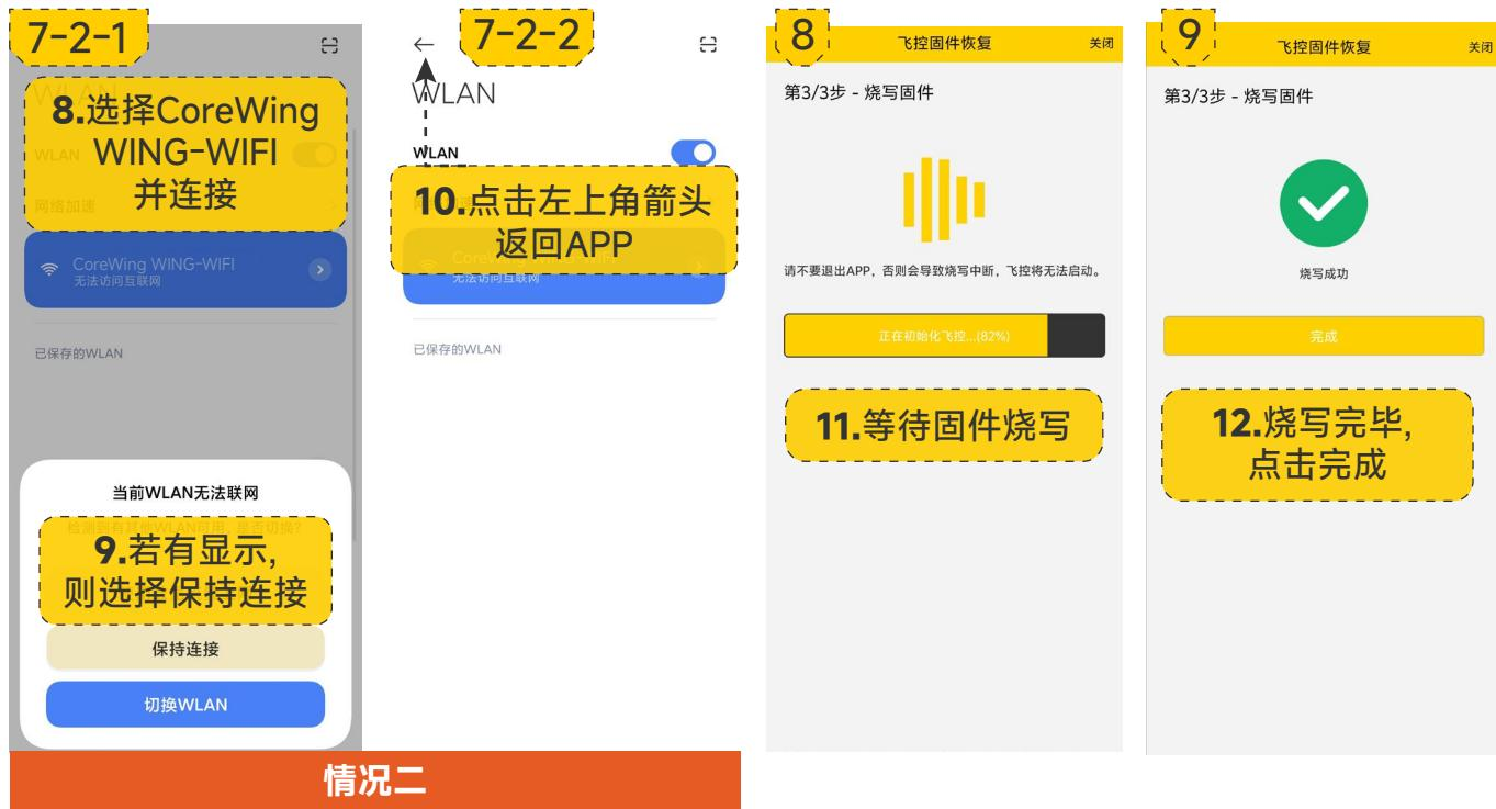
\*若飞控无法启动, 请先断开所有供电, 再按住BOOT键并重新供电, 以进行固件恢复。详细步骤请参照APP中的操作指引(如下图所示)。
